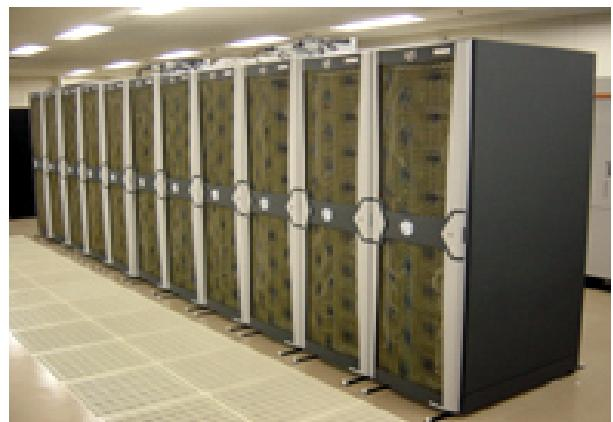
型論理共有メモリ超並列コンピュータで、システムは512Core(256CPU)で6TByteメモリーの演算ノードと、128Core(64CPU)で114TByteの高速ディスクとの間を40Gbps
