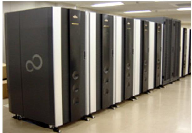
の共有メモリ型スカラ並列コンピューターで、システムは64Core(32CPU)を持つ演算ノード10台から構成されています。ノード間のデータ転送は、最大24TB
