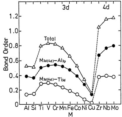
図2 M Ti<sub>10</sub> Al<sub>8</sub> クラスターの結合次数
