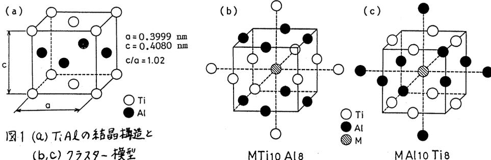
図1 (a) TiAlの結晶構造と
